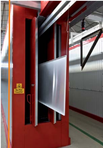
3 • Four de séchage et polymérisation Polymerisation and drying oven
